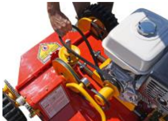
PASO 5 : Gire la correa 1/4 de vuelta hacia la derecha hasta coincidir con la polea del portacuchillas.
