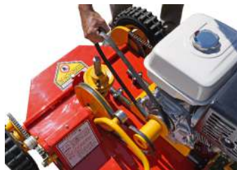
PASO 4: Coloque la correa nueva en la polea del motor.
