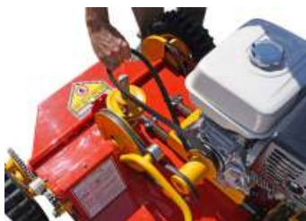
PASO 5: Gire la correa 1/4 de vuelta hacia la derecha hasta coincidir con la polea del portacuchillas.
