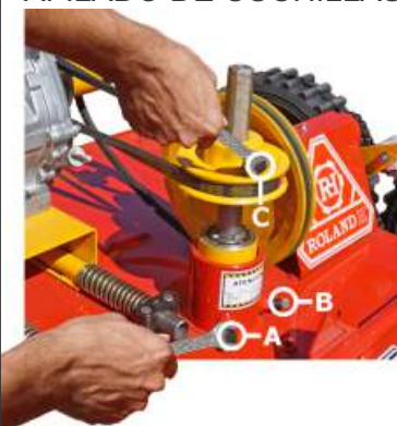
PASO 2: Desplace manualmente el motor hacia adelante. PASO 3: Retire la correa.
