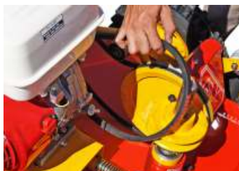
PASO 2: Desplace manualmente el motor hacia adelante. PASO 3: Retire la correa.
