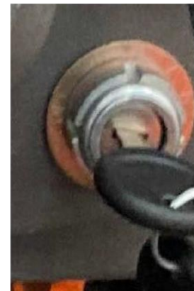
OFF - Apagado ACC - Fuente de alimentación auxiliar ON - Encendido ST - Arranque
