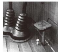
Pedal de bloqueo del diferencial
